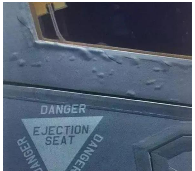
图 19. F-35 座舱边缘隐身涂层在海上环境中起泡开裂
