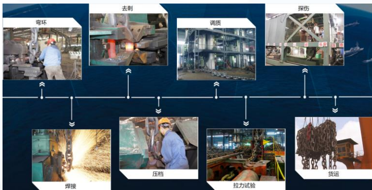
图、锚链生产涉及大直径特钢的焊接和热处理等多道工序
