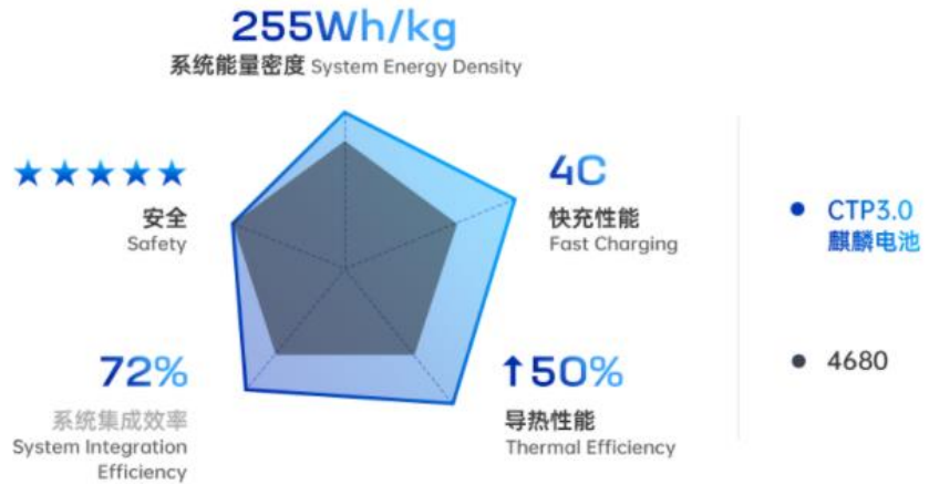
图 24 麒麟电池相比 4680 电池在多项性能上实现提升
