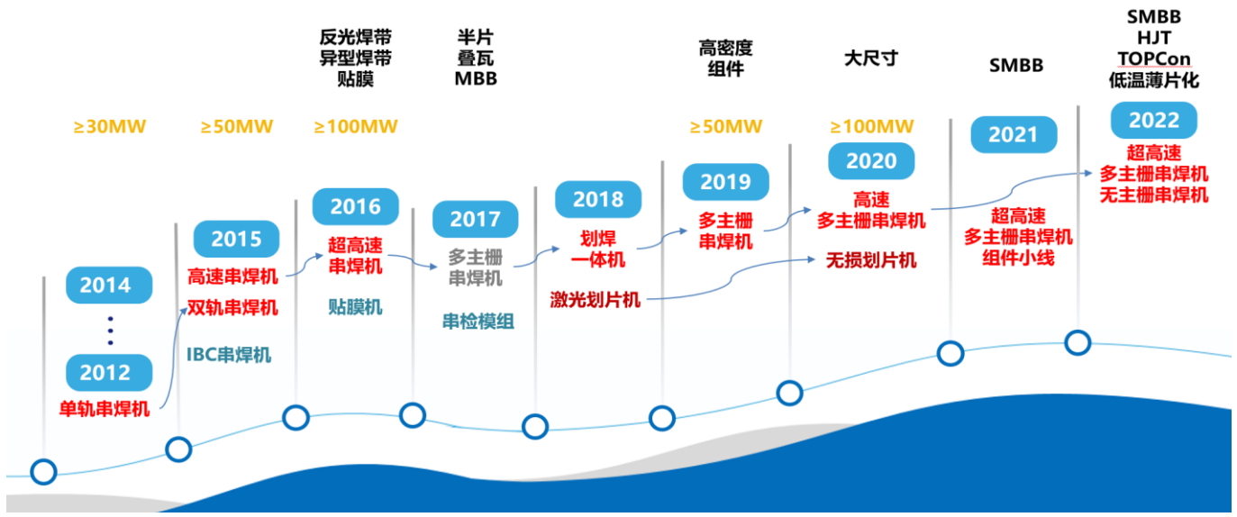
图表62：组件串焊机近年来实现多次技术迭代
