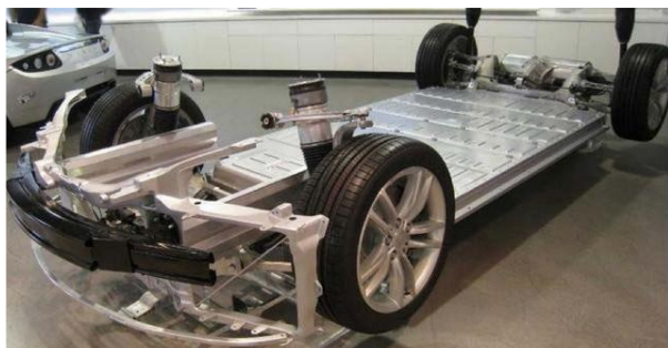
图54. 纯电动车结构简化
