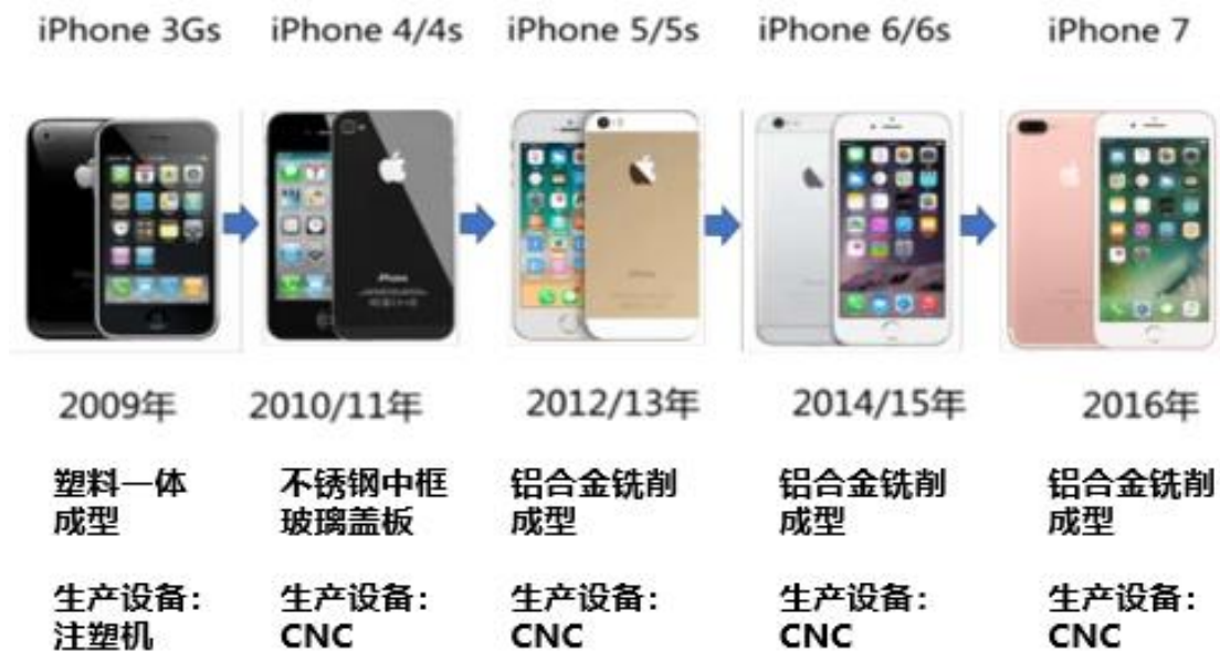
苹果手机结构件材质及加工设备变化
