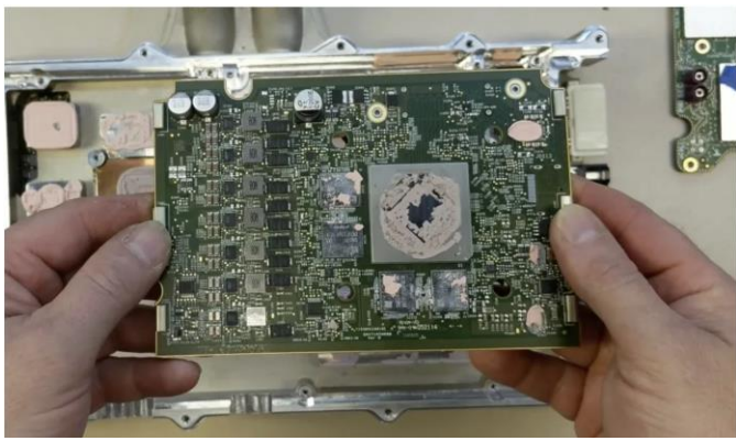
图23.特斯拉 Model s 可外接 AMD RDNA2 独立显卡
