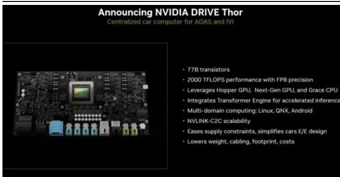
图32.Thor 单颗可实现 FP8 精度下 2000TFLOPS 算力
