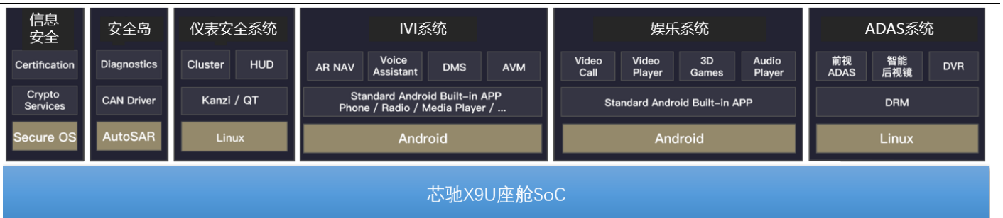
图1.芯驰 X9U 座舱 SoC 基于硬件虚拟化技术实现多操作系统及多座舱功能
