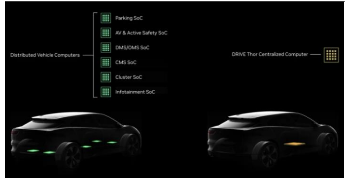
图33.中央计算+区域控制 E/E 架构示意图
