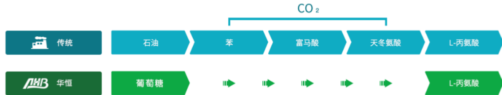
图 25：合成 L-丙氨酸的两种方式比较
